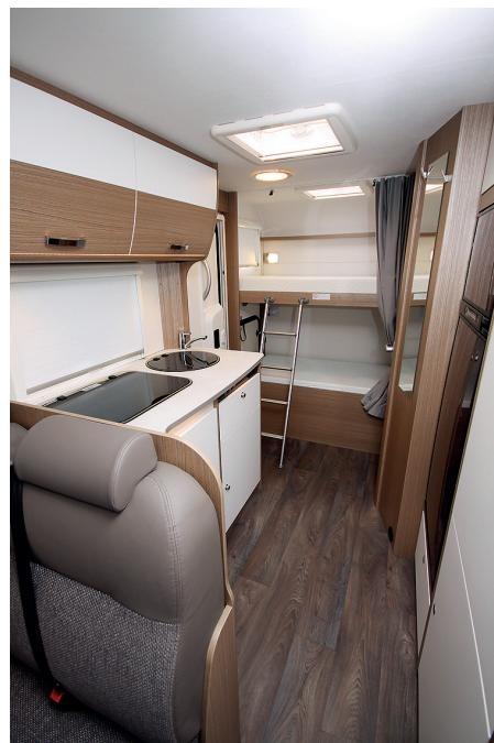
↑ V zadní části je u LMC příčné dvojlůžko, zatímco v Caradu jsou palandy. Tímto uspořádáním vzniká u kuchyně velký volný prostor. Vyzdvihnout je třeba také rovnou podlahu bez schodů u obou vozech.
